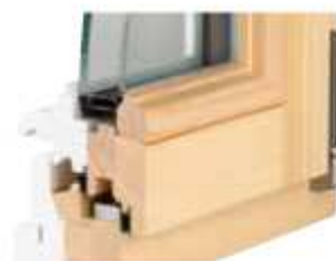
Cadre parclose à fixation invisible. Profil parclose « doucine », en option.
