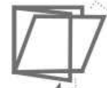
LES OSCILLO-BATTANTS 1 OU 2 VANTAUX Ventilation et ouverture totale. Cumulent les avantages des soufflets et des ouvertures à la française
